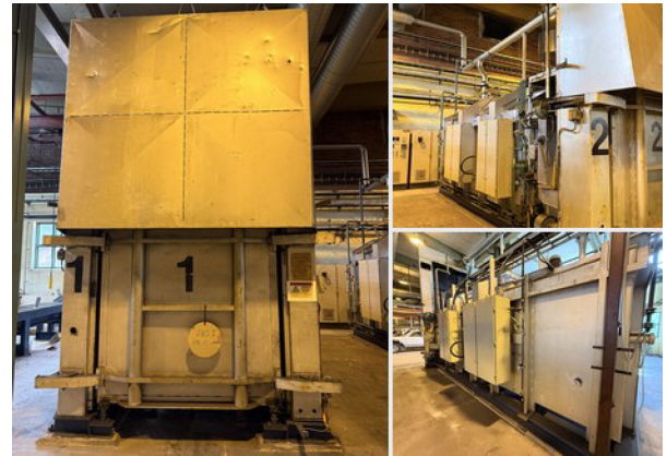
Batch annealing furnaces (UGNSBOLAGET), Erasteel Vikmanshyttan
