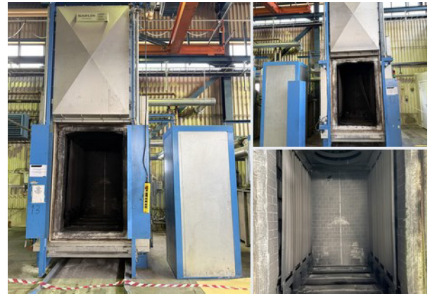
N2 batch annealing furnace (SARLIN AB), Erasteel Vikmanshyttan
