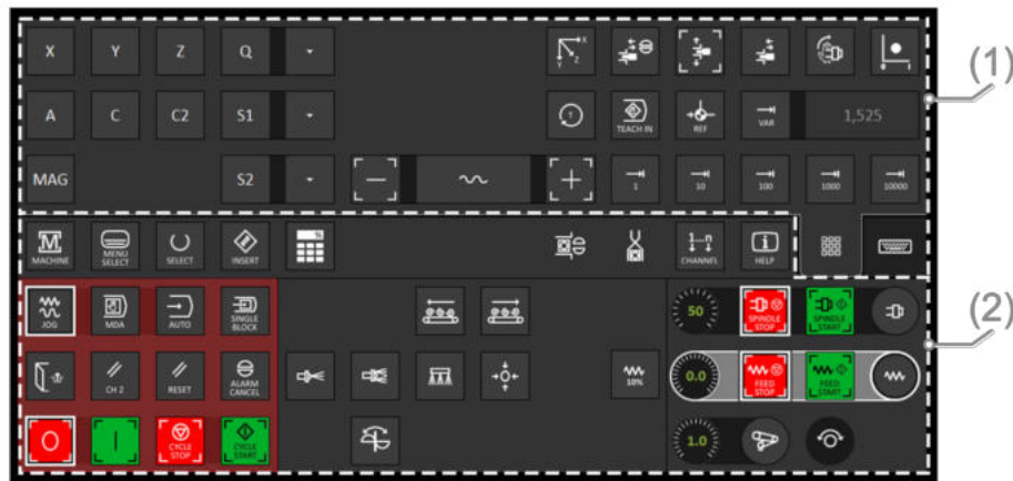
Abbildung 4: Maschinensteuertafel bei Steuerung aus
