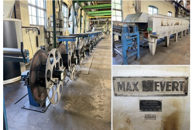
Oven 1 narrow strip stretch annealing furnace (MAX SIEVERT), Erasteel Vikmanshyttan
