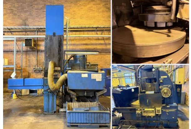
Stone circular surface grinder (KARLEBO/BLANCHARD), Erasteel Vikmanshyttan
