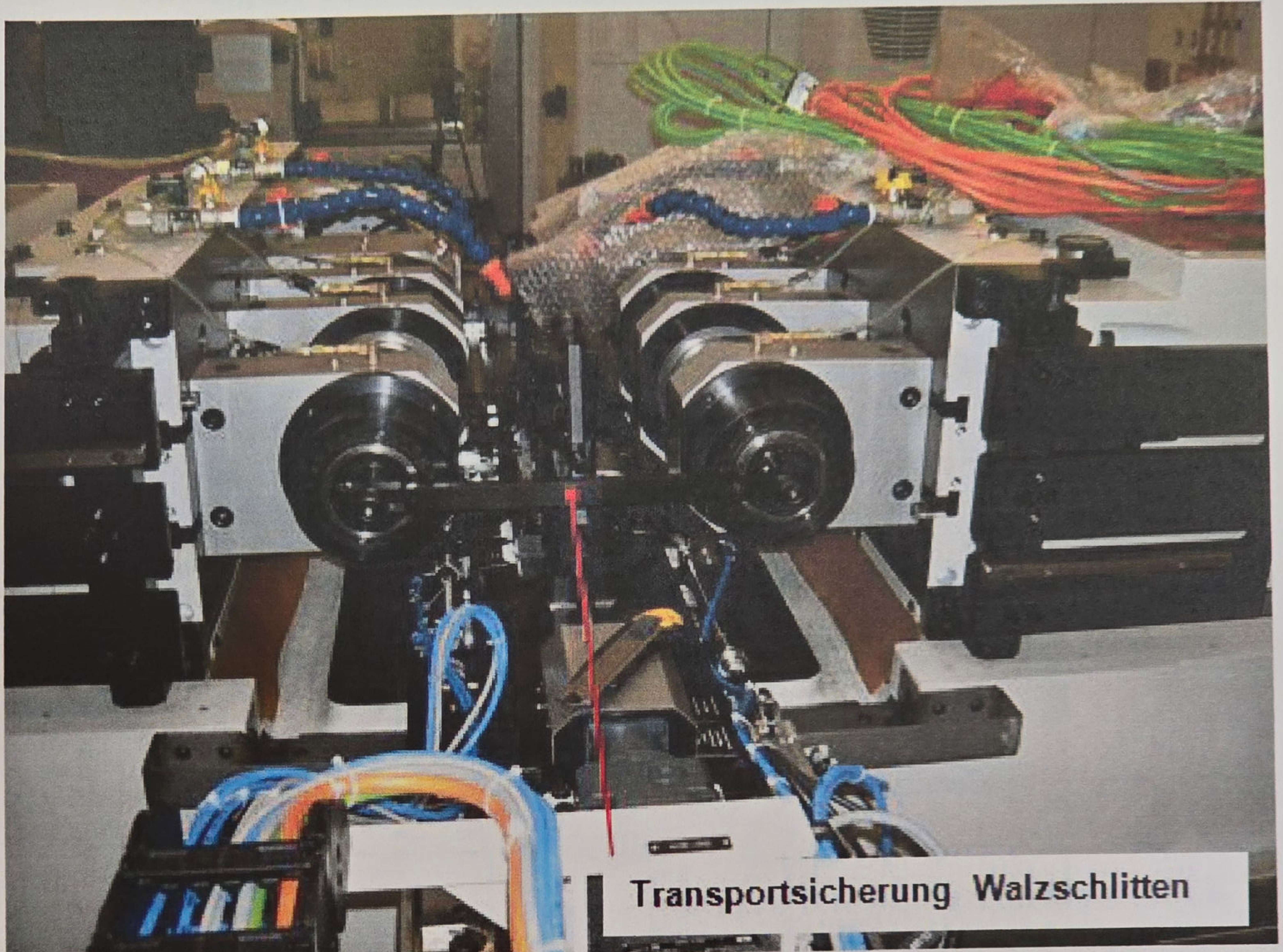
Abb. 12: Transportsicherung der Walzschlitten
