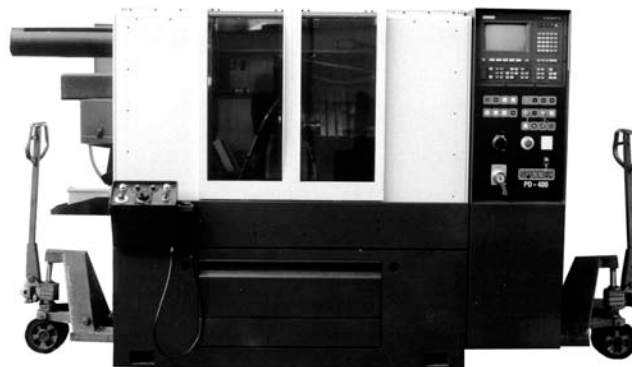
Abbildung 4-2: Verbringung der Maschine PD mit zwei Hubwagen
