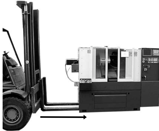
Abbildung 4-1: Verbringung der Maschine PD mit einem Gabelstapler
