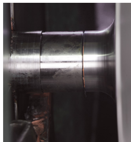
01 Ausgangssituation Beide Werkstücke werden fest eingespannt; ein Werkstück wird in Rotation versetzt.
