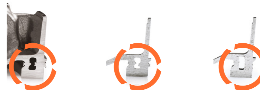
Reduzierung des Wulstes mit optimierten Parametern (von links nach rechts)
