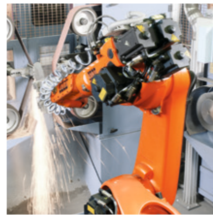
KR 60-3 HA Roboter beim automatisierten Schleifprozess
