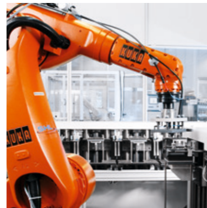
KR 30-3 beim automatisierten Handhaben von Metallteilen
